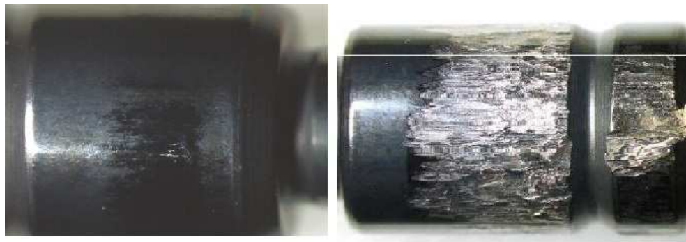
图 3.4 柱塞卡滞严重情况
