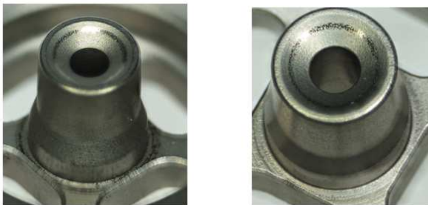
图 5.9 出油阀底座磨损示意图
