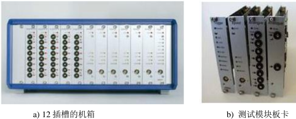
图 2.6 Rotec 前端数据采集系统硬件实物图
