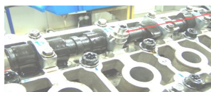
图 4.11 在凸轮轴支撑上安装压力传感器
