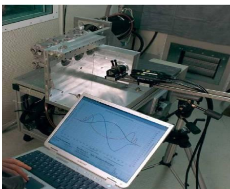
图 4.5 配气机构专用试验台
