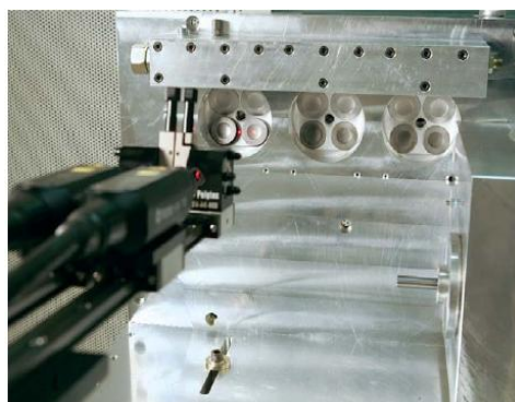
图 4.6 激光测距仪对准气门
